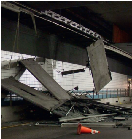
Consecuencias de un mal dimensionado en el anclaje o una aplicación mal realizada
