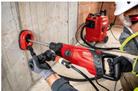
Perforadora DD150 taladrando a mano en hormigón armado con unidad de reciclado.
