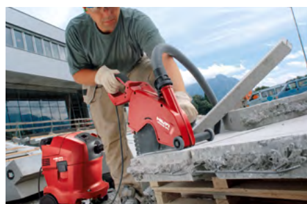
Perforadora eléctrica de cable DCH300 cortando hormigón sin polvo con aspirador.
