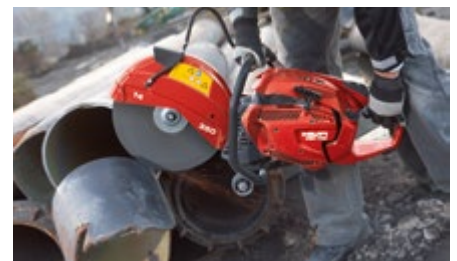
La DSH 700 corta tubos de acero con disco abrasivo.
